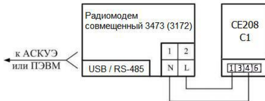
Рисунок 7. Схема подключения счетчика через PLC-интерфейс
