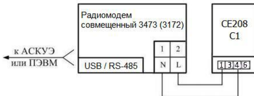
Рисунок 7. Схема подключения счетчика через PLC-интерфейс
