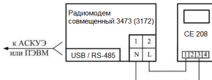
Рисунок 4 Схема подключения счетчика через PLC-интерфейс
