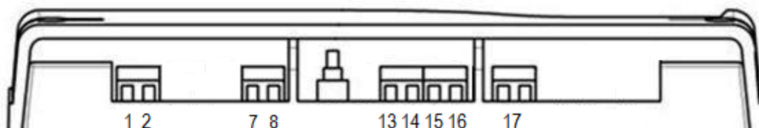
Рисунок 8. Обозначение функциональных контактов счетчика CE318 S31
