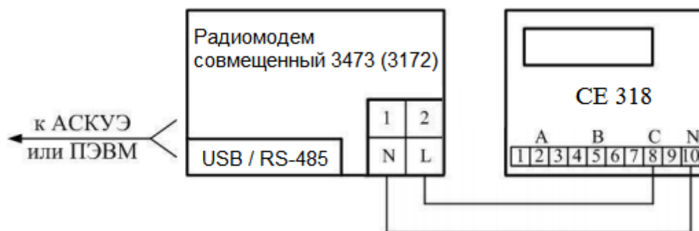
Рисунок 22. Схема подключения счетчика трансформаторного по току включения через PLC-интерфейс
