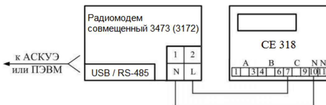
Рисунок 23. Схема подключения счетчика непосредственного включения через PLC-интерфейс
