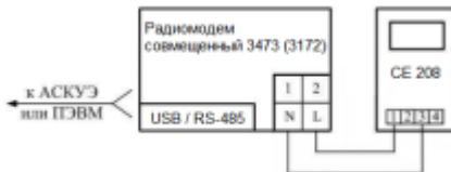
Рисунок 13 Схема подключения счетчика через PLC-интерфейс
