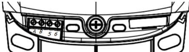
Рисунок 7. Обозначение функциональных контактов счетчика S51, S53 исполнения с RS-485
