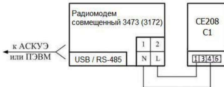
Рисунок 7. Схема подключения счетчика через PLC-интерфейс
