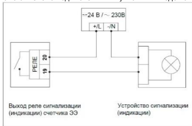
Рисунок 5.7 – Схема подключения выходов высоковольтного реле сигнализации
