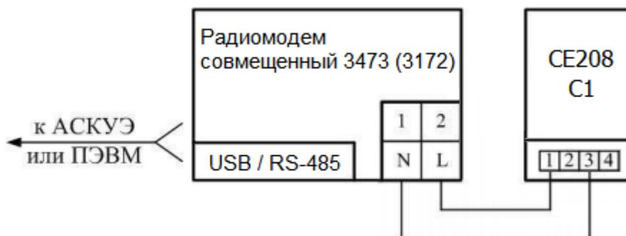
Рисунок 7. Схема подключения счетчика через PLC-интерфейс
